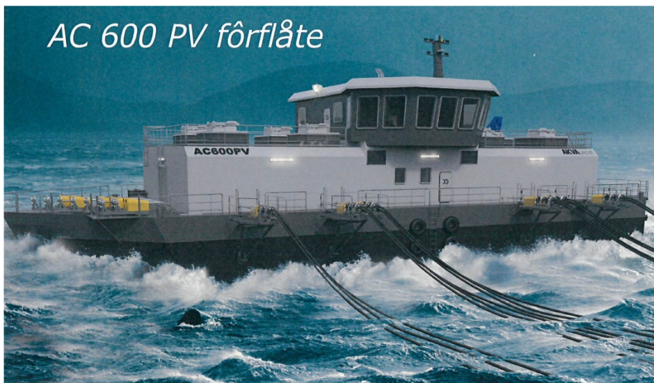
Figur 26. Eksempel på fôringsflåte. Denne vil bli liggende ved kai. Illustrasjon fra AKVA group.
