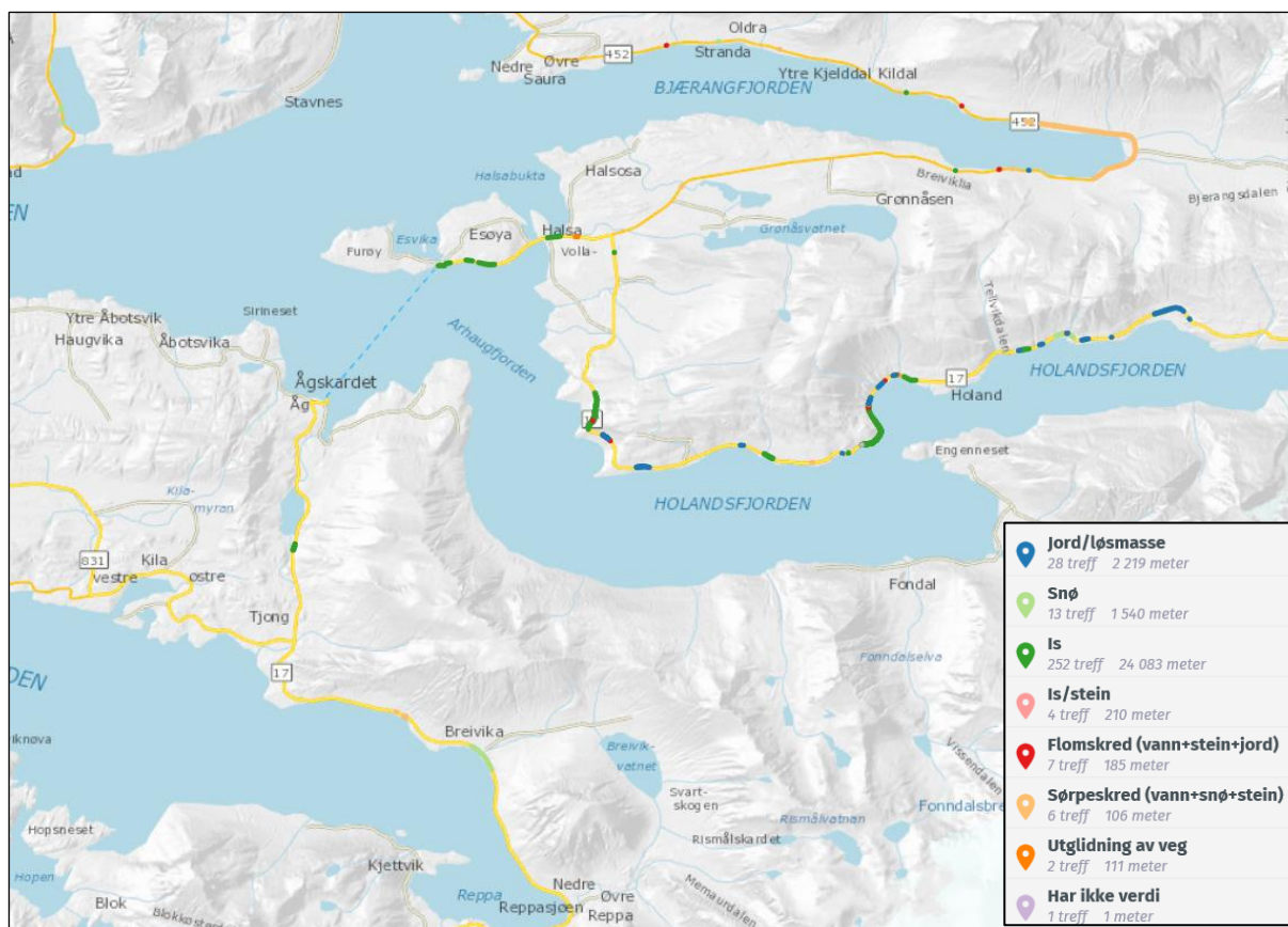
Figur 6: Registrerte skredhendelser fordelt på type skred ved Storvika – Reppen . Fra Statens vegvesens Vegkart.
