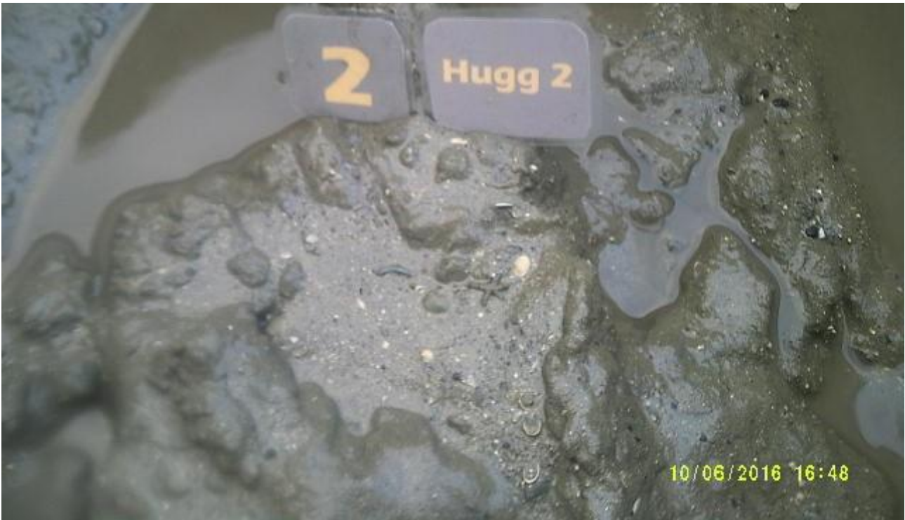
Figur 4: Bilde av sedimentet ved referansestasjonen. Sedimentet besto av leire, sand, grus og skjellsand, og hadde en pelittandel på 70% (se Akvaplan-niva rapport i Vedlegg A ). Foto: Aqua Kompetanse AS.
