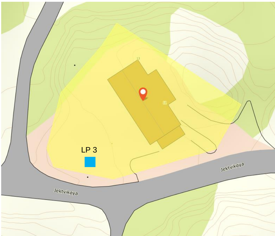
Figur 8: Påvist forurensning i dypereliggende jord ved område 1. Prøvepunktene er fargekodet iht. tilstandsklassene i Miljødirektoratets veileder for forurenset grunn. Kartkilde: Norgeskart.no
