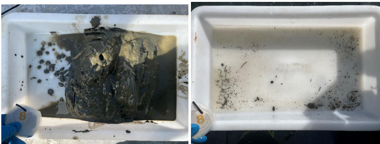
Figur 13: Bilder som viser sedimentet fra stasjon 8 før og etter siling. Sedimentet besto av silt, og noe leire og skjellsand. Foto: Aqua Kompetanse AS.
