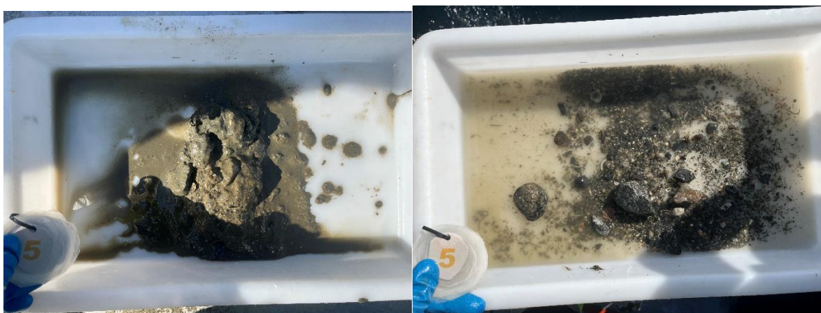
Figur 10: Bilder som viser sedimentet fra stasjon 5 før og etter siling. Sedimentet besto av skjellsand, og noe silt og grus. Det ble også registrert steinbunn. Foto: Aqua Kompetanse AS.
