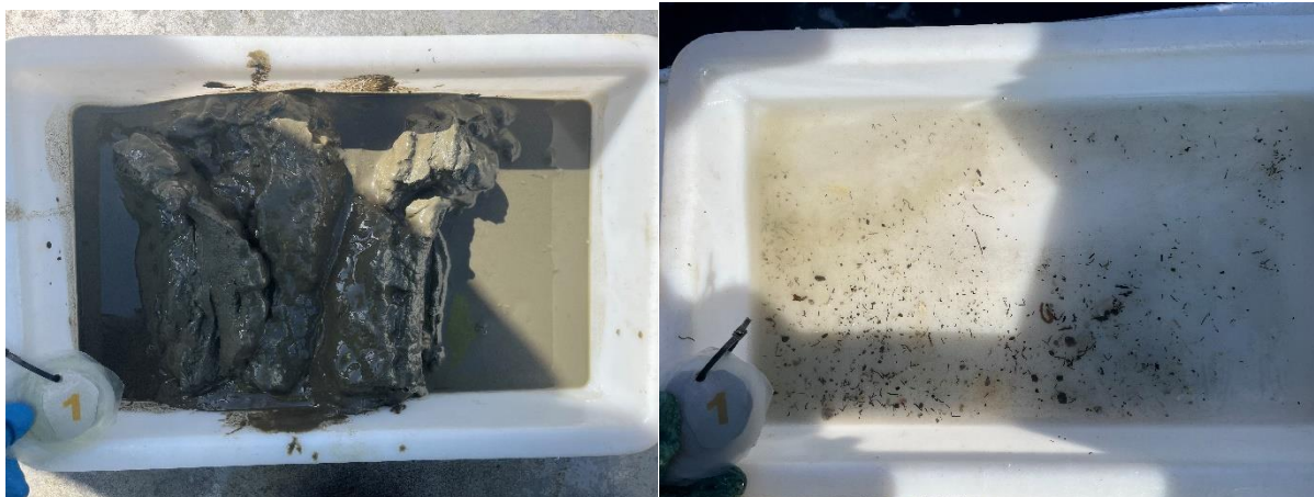
Figur 6: Bilder som viser sedimentet fra stasjon 1 før og etter siling. Sedimentet besto av silt, og noe leire og skjellsand. Foto: Aqua Kompetanse AS.
