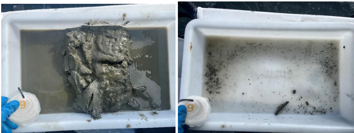
Figur 14: Bilder som viser sedimentet fra stasjon 9 før og etter siling. Sedimentet besto av silt, og noe leire og skjellsand. Foto: Aqua Kompetanse AS.
