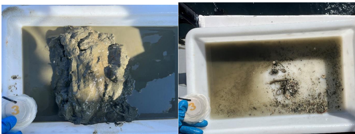
Figur 8: Bilder som viser sedimentet fra stasjon 3 før og etter siling. Sedimentet besto av silt og leire, og noe skjellsand. Foto: Aqua Kompetanse AS.
