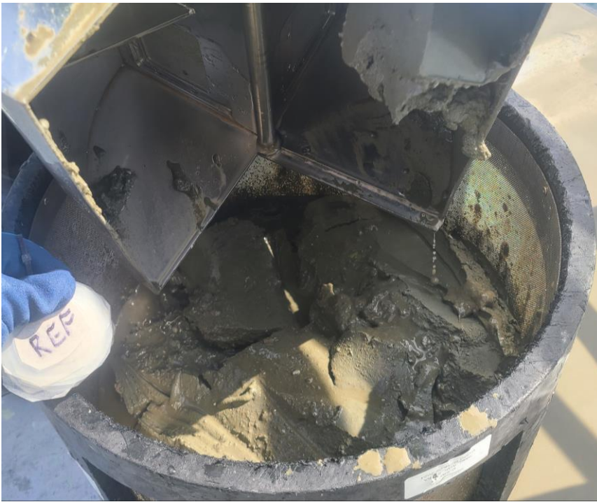
Figur 9-5: Bilde av sedimentet ved C-ref. Sedimentet besto av leire og silt. Foto: Aqua Kompetanse AS.
