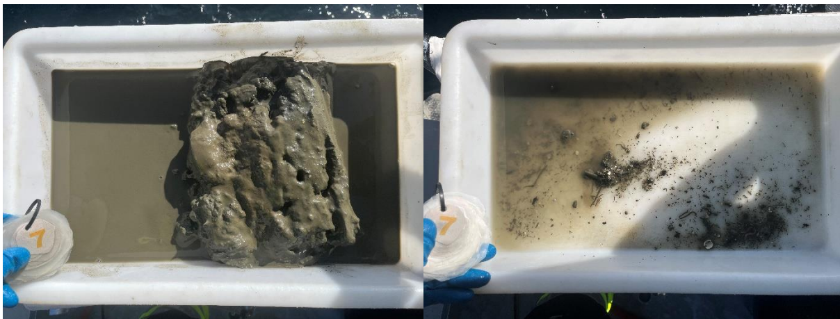
Figur 12: Bilder som viser sedimentet fra stasjon 7 før og etter siling. Sedimentet besto av silt, og noe leire og skjellsand. Foto: Aqua Kompetanse AS.
