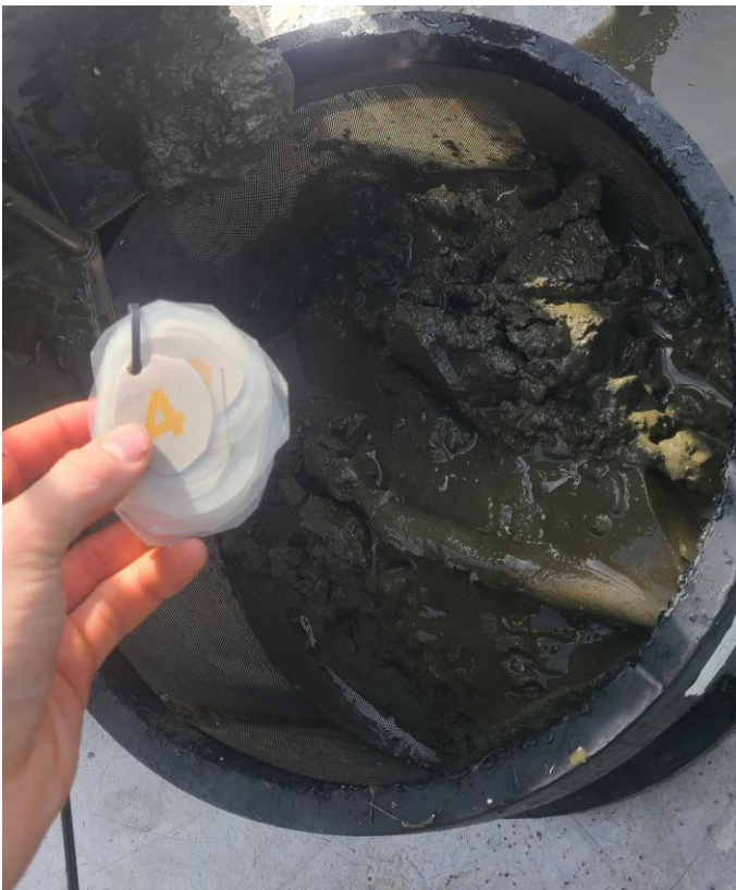
Figur 9-4: Bilde av sedimentet ved C4. Sedimentet besto av leire og silt. Foto: Aqua Kompetanse AS.
