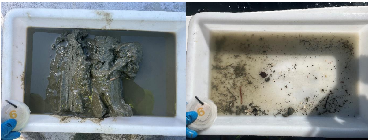
Figur 11: Bilder som viser sedimentet fra stasjon 6 før og etter siling. Sedimentet besto av silt, og noe leire og skjellsand. Foto: Aqua Kompetanse AS.
