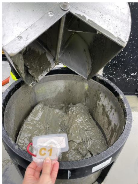
Figur 9-1: Bilde av sedimentet ved C1. Sedimentet besto av leire, silt og sand. Foto: Aqua Kompetanse AS.
