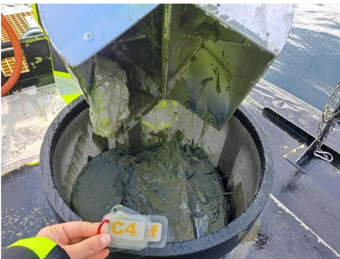
Figur 9-4: Bilde av sedimentet ved C4. Sedimentet besto av leire, silt og sand. Foto: Aqua Kompetanse AS.
