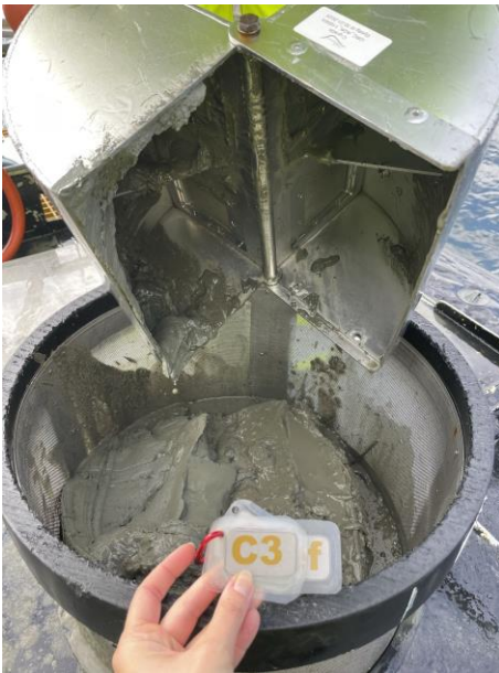
Figur 9-3: Bilde av sedimentet ved C3. Sedimentet besto av leire og silt. Foto: Aqua Kompetanse AS.
