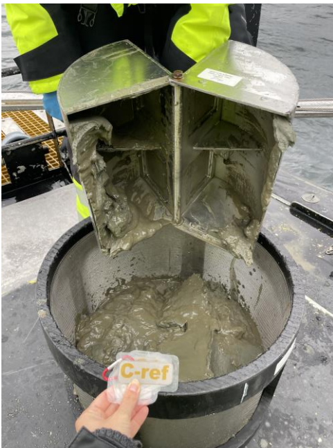
Figur 9-6: Bilde av sedimentet ved Cref. Sedimentet besto av leire, sand og silt. Foto: Aqua Kompetanse AS.
