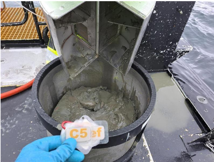
Figur 9-5: Bilde av sedimentet ved C5. Sedimentet besto av leire. Foto: Aqua Kompetanse AS.
