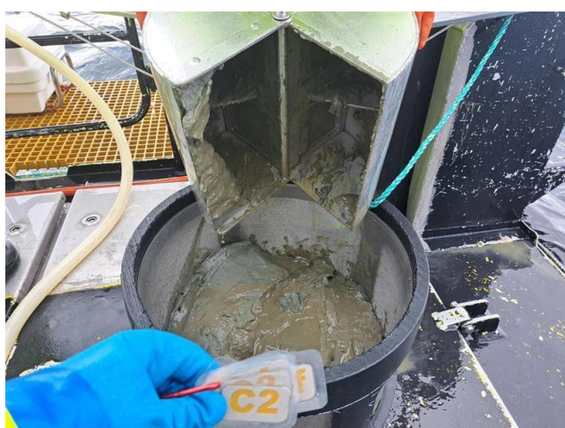
Figur 9-2: Bilde av sedimentet ved C2. Sedimentet besto av leire. Foto: Aqua Kompetanse AS.
