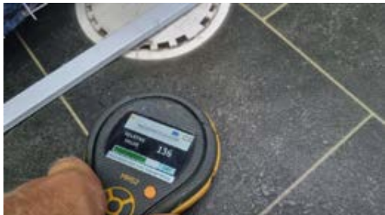
Fuktmåling i gulvet.
