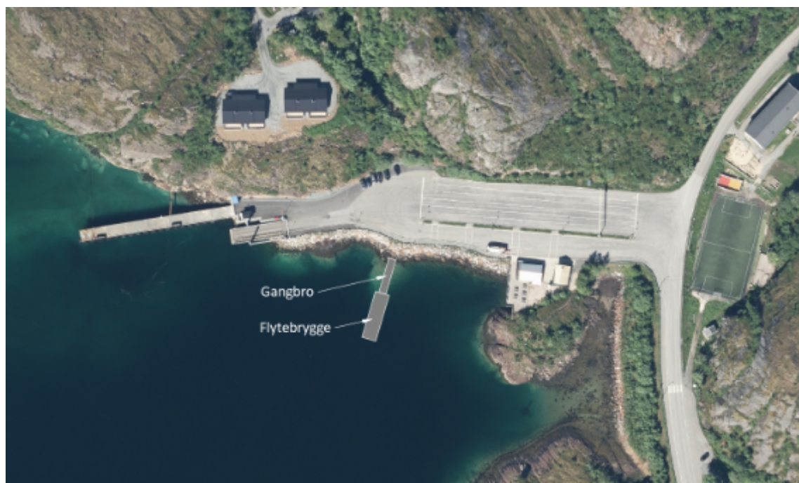
Figur 1: Skisse og plassering av flytebrygge på Jektvik fergekai
