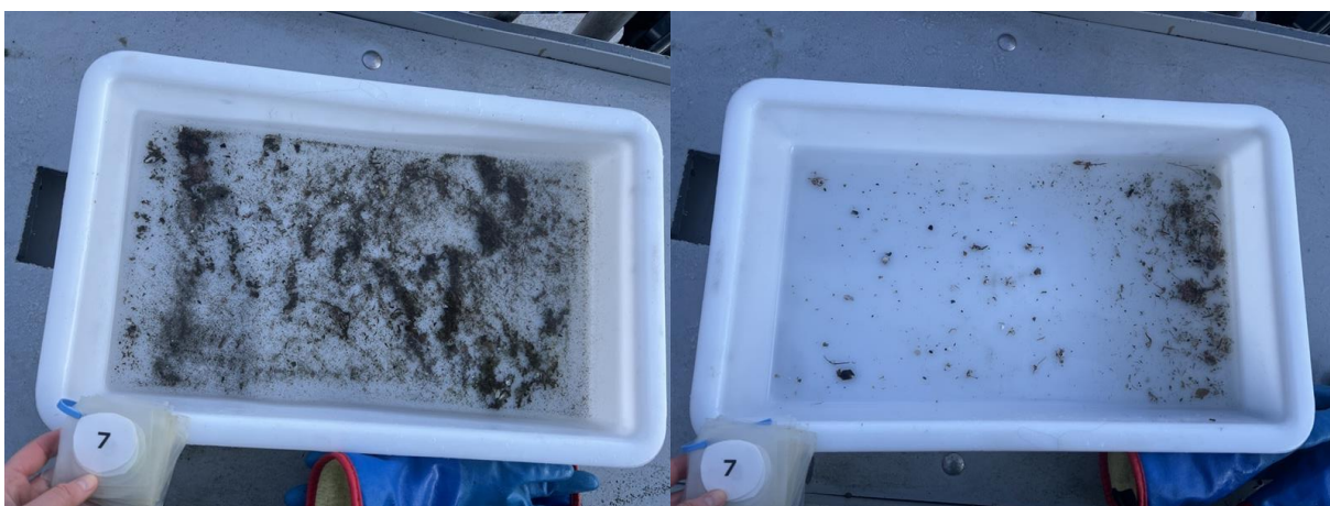
Figur 10: Bilder som viser sedimentet fra stasjon 7 før og etter siling. Sedimentet besto av silt, og det ble også registrert fjellbunn ved stasjonen. Det ble registrert fekalier i prøven. Foto: Aqua Kompetanse AS.
