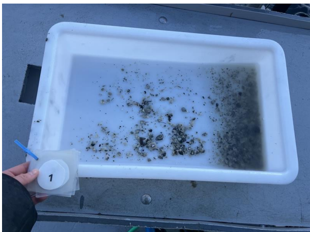
Figur 6: Bilde som viser sedimentet fra stasjon 1 etter siling. Bilde før spyling ble avglemt. Sedimentet besto av leire, og det ble også registrert fjellbunn ved stasjonen. Det ble registrert fekalier i prøven. Foto: Aqua Kompetanse AS.
