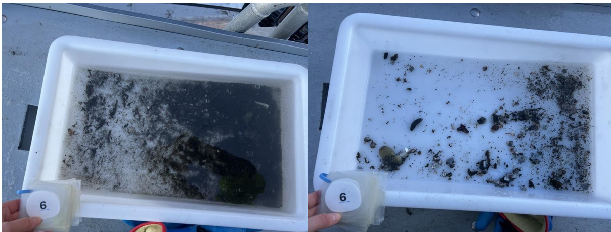
Figur 9: Bilder som viser sedimentet fra stasjon 6 før og etter siling. Sedimentet besto av silt, og det ble også registrert fjellbunn ved stasjonen. Det ble registrert fekalier i prøven. Foto: Aqua Kompetanse AS.
