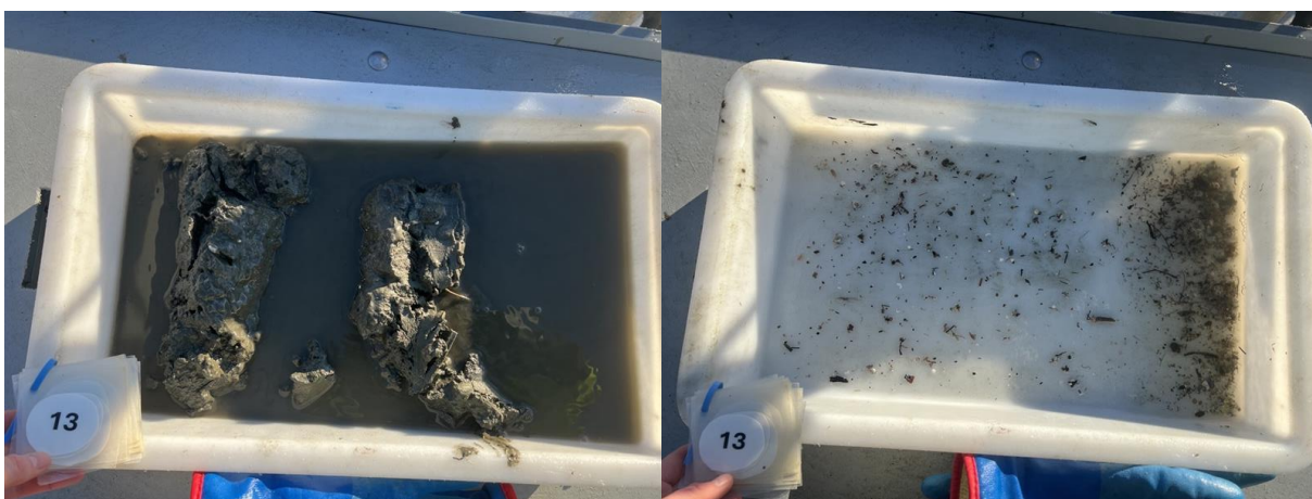
Figur 16: Bilder som viser sedimentet fra stasjon 13 før og etter siling. Sedimentet besto av leire. Foto: Aqua Kompetanse AS.
