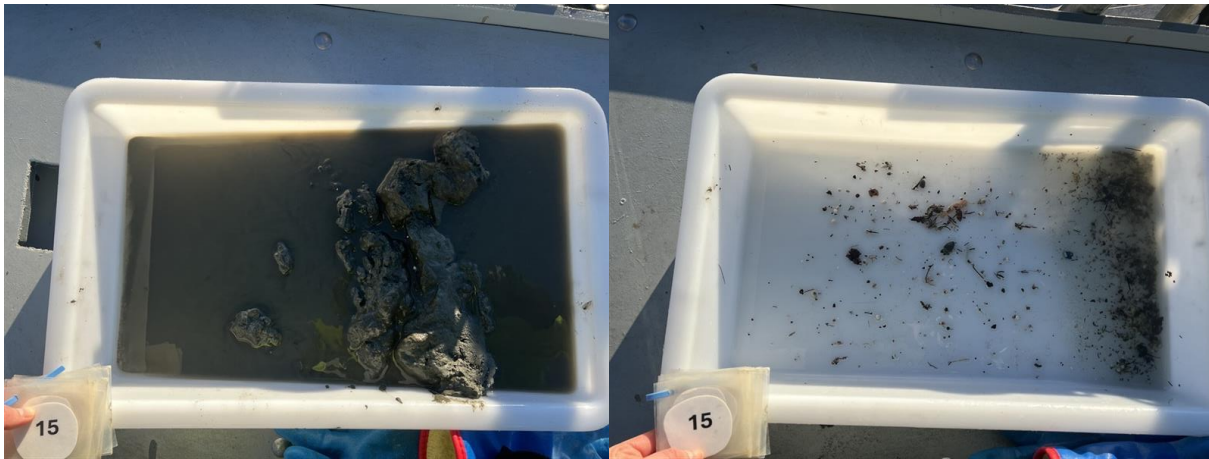
Figur 18: Bilder som viser sedimentet fra stasjon 15 før og etter siling. Sedimentet besto av leire. Foto: Aqua Kompetanse AS.
