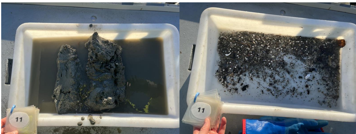
Figur 14: Bilder som viser sedimentet fra stasjon 11 før og etter siling. Sedimentet besto av leire, grus og skjellsand. Foto: Aqua Kompetanse AS.
