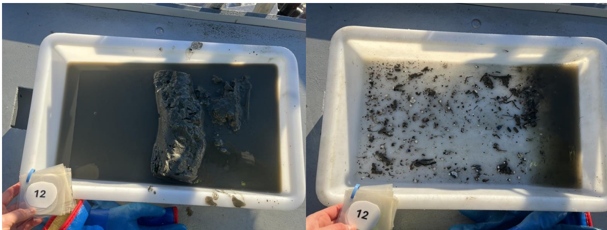
Figur 15: Bilder som viser sedimentet fra stasjon 12 før og etter siling. Sedimentet besto av leire og grus. Foto: Aqua Kompetanse AS.
