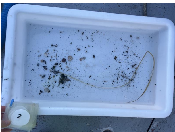
Figur 7: Bilde som viser grabbinnholdet fra stasjon 2. Sedimentet besto av sand, og det ble registrert fjellbunn ved stasjonen. Det ble registrert fekalier i prøven. Foto: Aqua Kompetanse AS.
