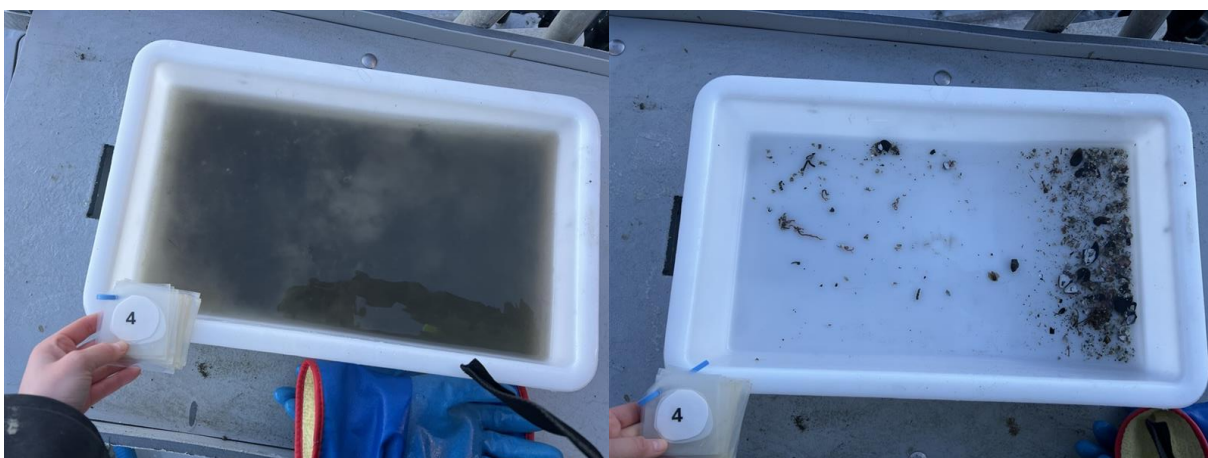
Figur 8: Bilder som viser sedimentet fra stasjon 4 før og etter siling. Sedimentet besto av skjellsand og silt. Det ble også registrert fjellbunn ved stasjonen. Foto: Aqua Kompetanse AS.
