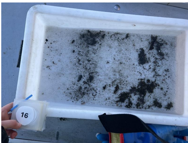
Figur 19: Bilde som viser grabbinnholdet fra stasjon 16. Sedimentet besto av silt, og det ble registrert fjellbunn ved stasjonen. Foto: Aqua Kompetanse AS.
