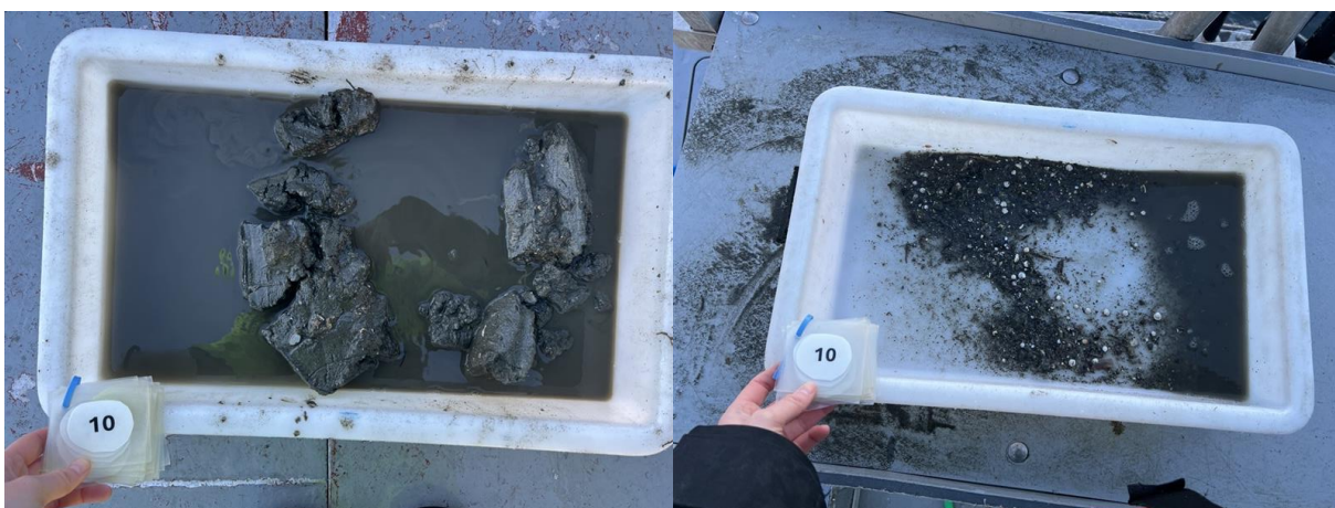
Figur 13: Bilder som viser sedimentet fra stasjon 10 før og etter siling. Sedimentet besto av leire, silt og sand. Foto: Aqua Kompetanse AS.
