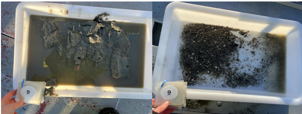
Figur 12: Bilder som viser sedimentet fra stasjon 9 før og etter siling. Sedimentet besto av leire, sand og grus. Foto: Aqua Kompetanse AS.
