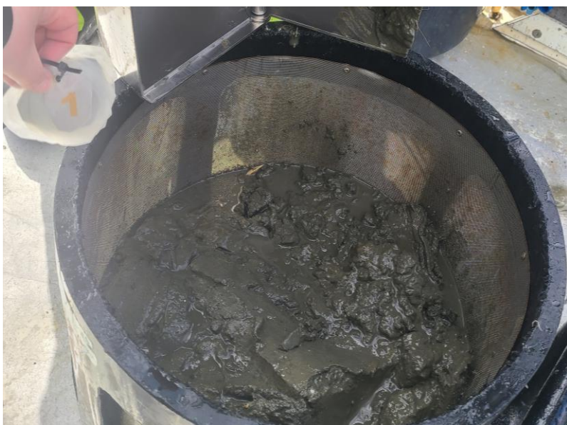
Figur 9-1: Bilde av sedimentet ved C1. Sedimentet besto av silt og sand. Foto: Aqua Kompetanse AS.
