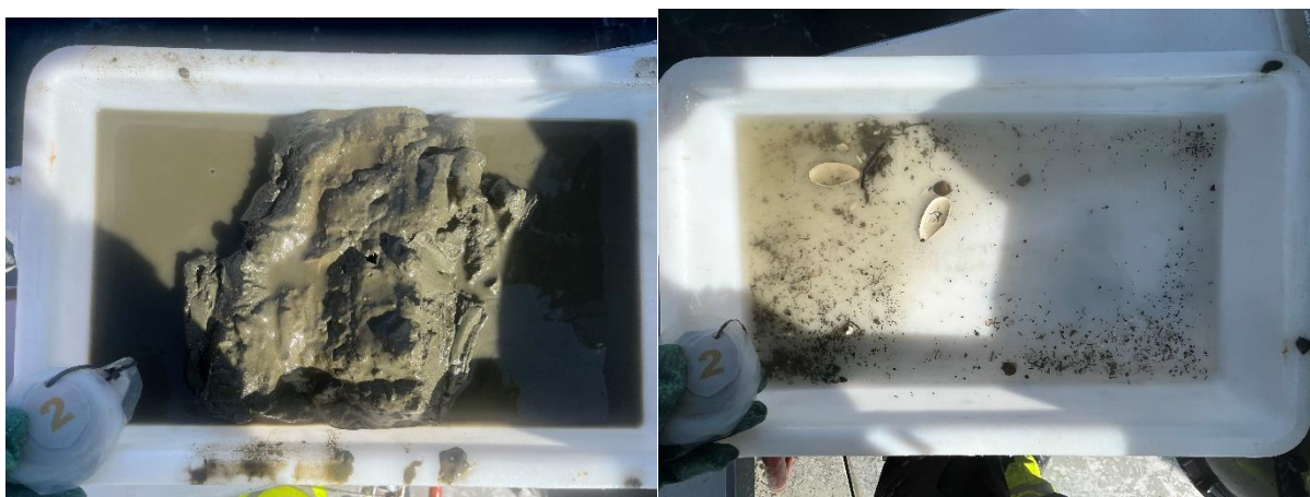
Figur 7: Bilder som viser sedimentet fra stasjon 2 før og etter siling. Sedimentet besto av silt, og noe leire og skjellsand. Foto: Aqua Kompetanse AS.
