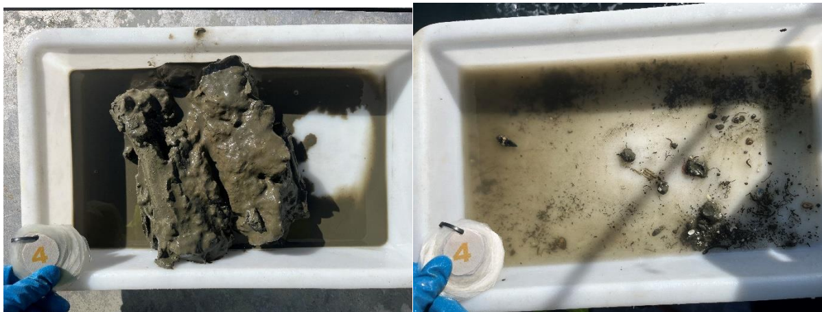
Figur 9: Bilder som viser sedimentet fra stasjon 4 før og etter siling. Sedimentet besto av silt, og noe leire og skjellsand. Foto: Aqua Kompetanse AS.
