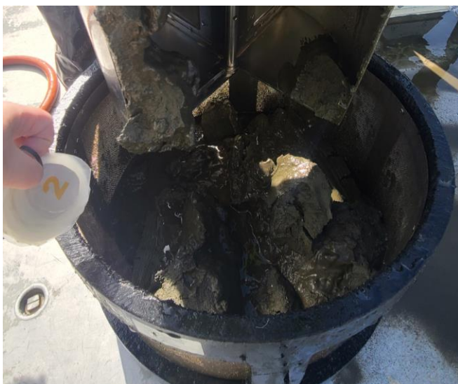
Figur 9-2: Bilde av sedimentet ved C2. Sedimentet besto av silt og leire. Foto: Aqua Kompetanse AS.
